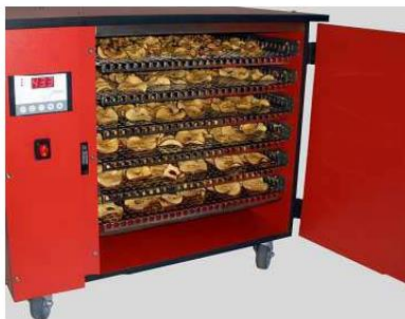
Figura 42 Mini-uscătorul tip Innotech – Hohenheim (sursa: www.prody-solar.de )
