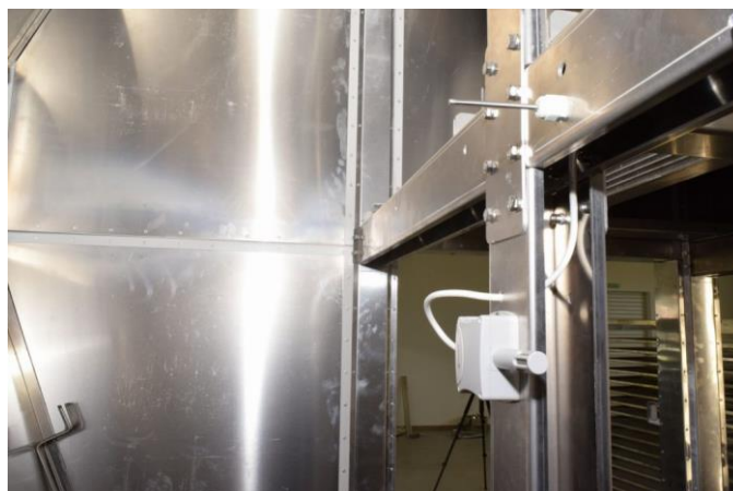
Figura 31 - Senzori pentru masurarea parametrilor aerului în uscator
