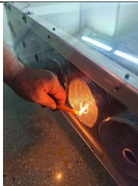
Testul cu flacara pentru evidentierea absorbtiei aerului atmosferic da catre ventilator
