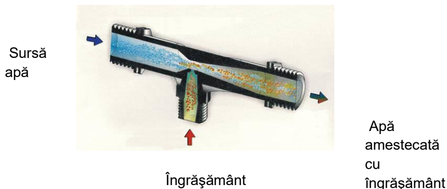
Fig. 7.2 Principiul de functionare al injectorului Venturi
