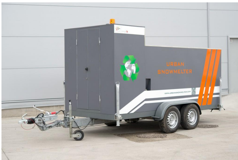
Fig. 45. Mașina de topit zăpada URBAN SNOW MELTER
