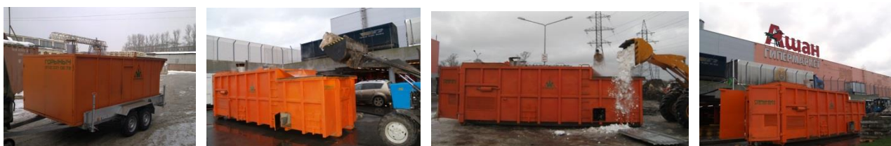
Fig. 47. Mașina de topit zăpada tip TZ - D
