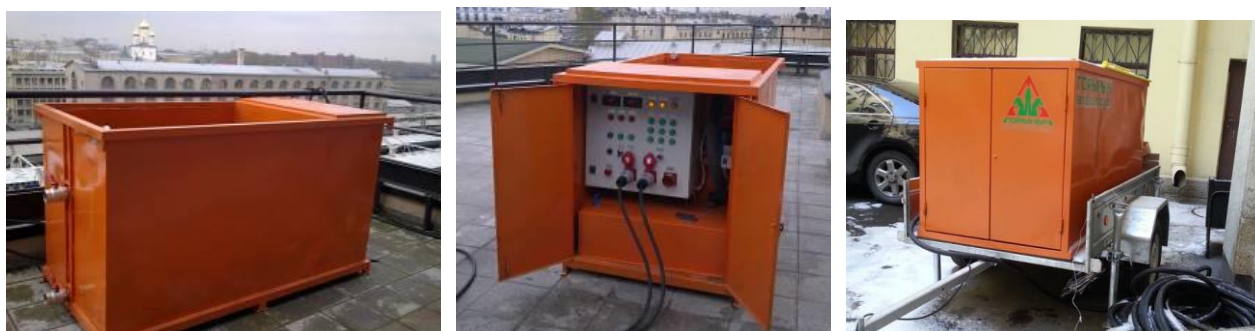
Fig. 48. Mașina de topit zăpada tip TZ - E
