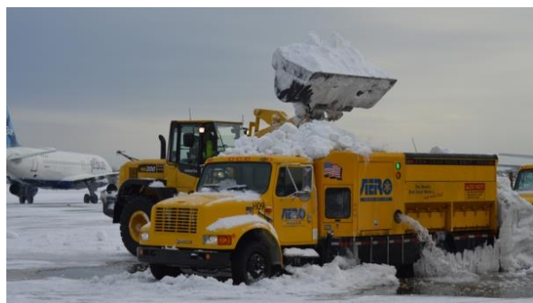
Fig. 39. Mașina de topit zăpada - Varianta mobilă 150 t/h
