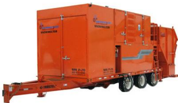
Fig. 18. Mașina de topit zăpada SRS-P70
