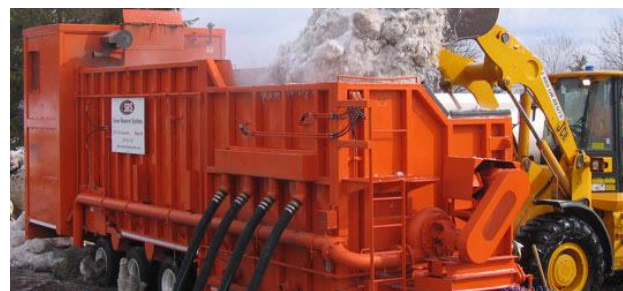
Fig. 19. Mașina de topit zăpada SRS-P100
