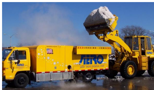
Fig. 39. Mașina de topit zăpada - Varianta mobilă 150 t/h
