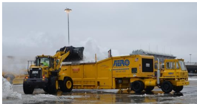
Fig. 38. Mașina de topit zăpada Aero 600 t/h
