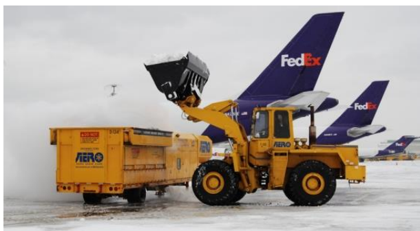
Fig. 37. Mașina de topit zăpada Aero 350 t/h
