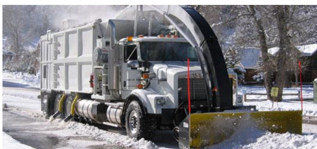
Fig. 20. Mașina de topit zăpada SRS-M150
