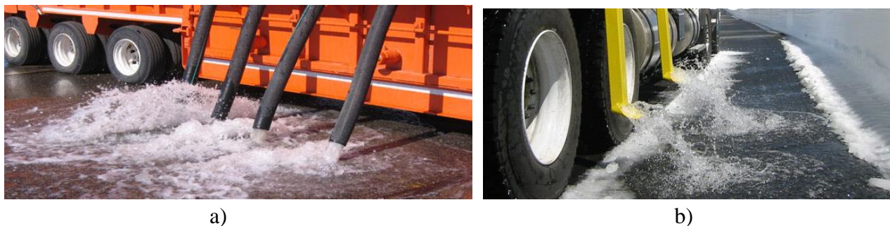
Fig. 25. Sisteme de evacuare a zăpezii topite
