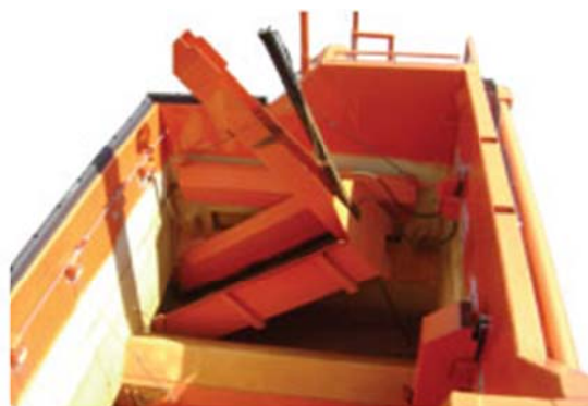
Fig. 7 Sistem hidraulic de înclinare cuvă de topire pentru eliminarea reziduurilor
