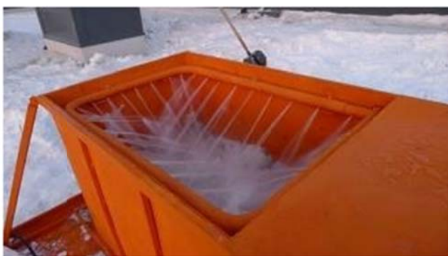
Fig. 6 Sistem de pulverizare apă caldă în cuva de topire
