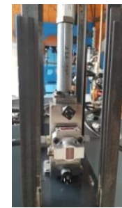
Fig.4: Servocilindru de urmărire (compensator activ de valuri).
