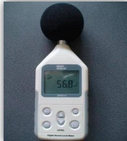
**Fig. 8.** Smart Sensor AR 814 Soundmeter
