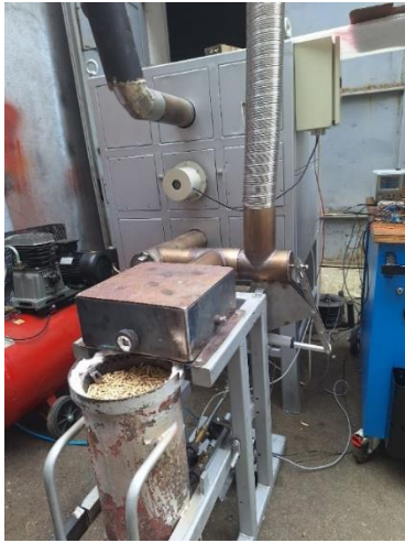
Fig. 1. Uscător convectiv cu independență energetică în raport cu rețeaua de energie electrică
