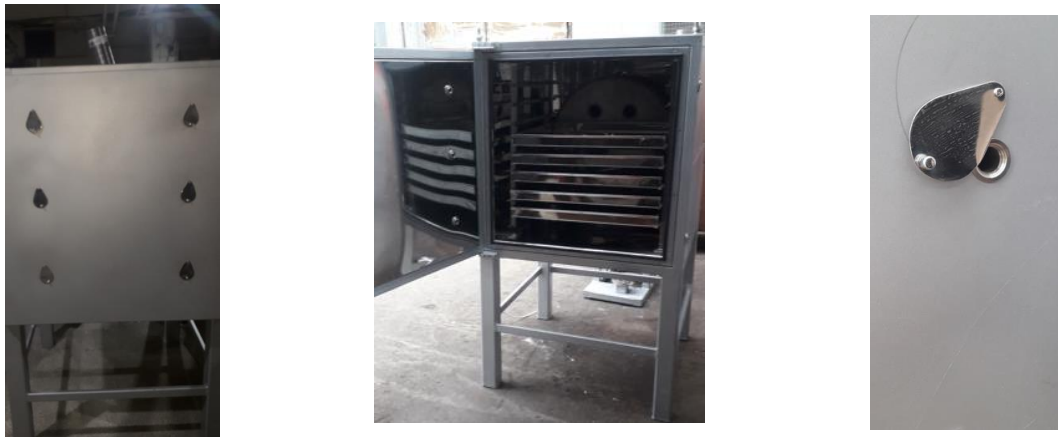
Fig. 26 Usa uscatorului convectiv, cu clapete de acces a aerului proaspat in incinta de uscare
