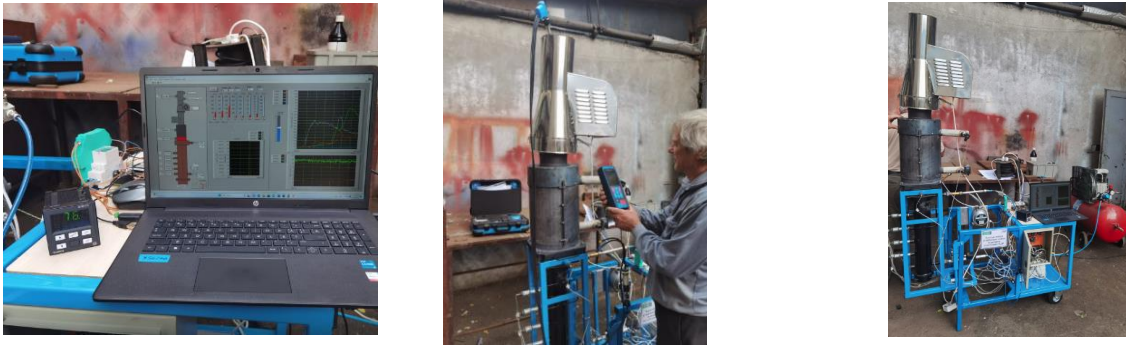
Fig. 31 Imagini din timpul testarii in conditii de laborator a ansamblului schimbator de caldura fum-aer amplasat in exteriorul incintei de uscare –camera de ardere pe instalatia de generare energie termica tip TLUD, folosind senzori si sisteme automate
