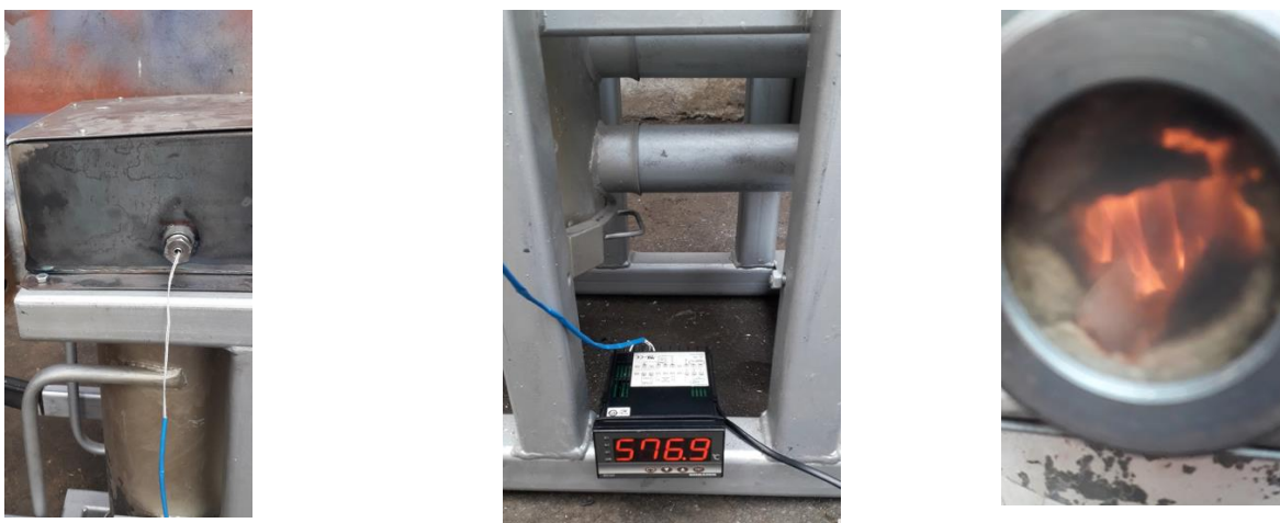
Fig. 27 Echipamentul de monitorizare a temperaturii in camera de ardere (termocupla de 1000 0C si afisorul digital cu intrari multiple: termocuple, senzori temperatura rezistivi (Pt 100, cod 31, cu domeniul de temperaturi -200...+600 0C), tensiune, curent; vizor de urmarire a procesului de ardere
