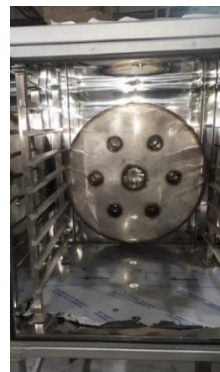
Fig. 22 Schimbător de căldură amplasat în incinta de uscare a- desen explicativ; b-realizare fizica
