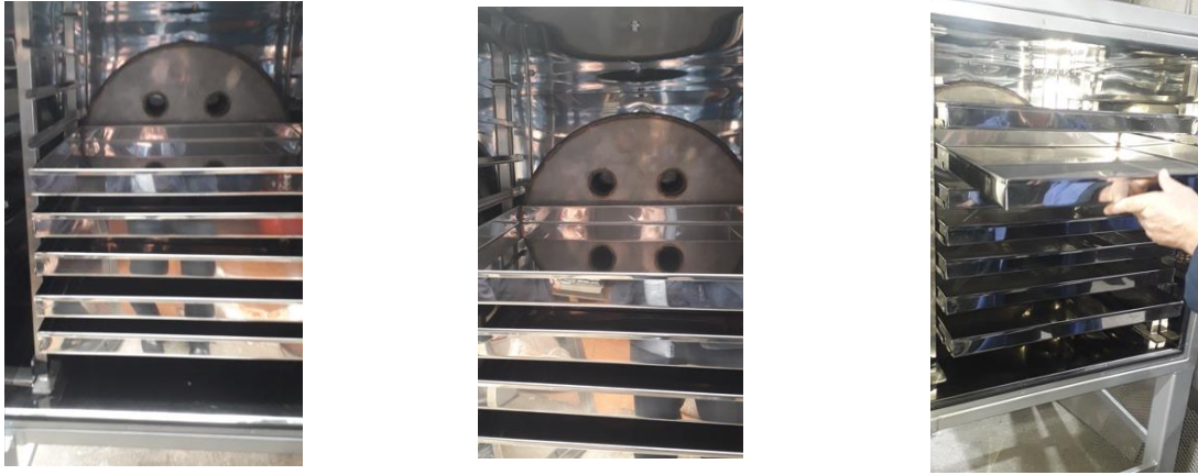
Fig. 25 Imagini din incinta de uscare a uscatorului convectiv: rastele cu tavi de asezare a produselor vegetale, schimbator de caldura
