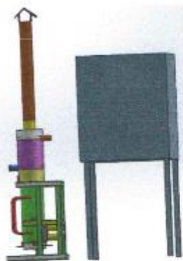
Uscator convectiv (modul termic si incinta de uscare cu casete)
